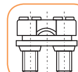
Клемма 2xM6 (6-70 мм 2 Cu)
