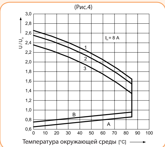
Рабочий диапазон напряжения DC катушки (Рис.4)
